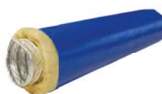
Type T.. ALU CR : conduit intérieur aluminium et pare-vapeur en PVC. Epaisseur d'isolant 25 mm 2 diamètres disponibles : 80 mm et 125 mm.
