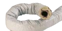
Type CR : conduit intérieur PVC type B et pare-vapeur en PVC, épaisseur de l'isolant 25 mm.
