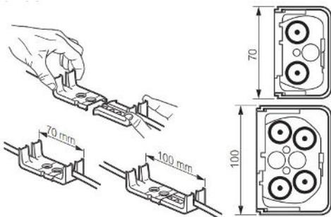
Les supports sont munis de colliers (ouvrable et verrouillable) pour la fixation des liaisons frigorifiques.
