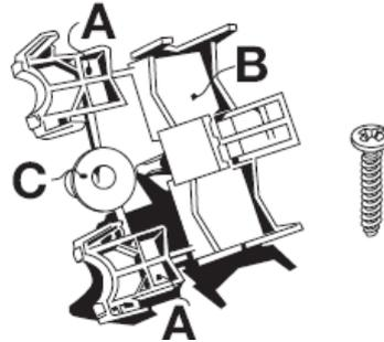
Support à assembler en fonction du diamètre des tuyaux utilisés
