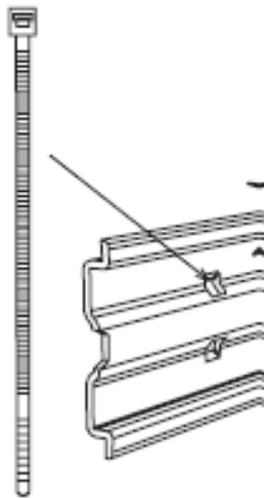
possibilité d'installer des agrafes de retenue (fournies avec la base plane) qui permettent le maintien des tubes.
