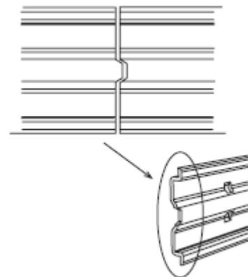
L'absence de retours d'aile (base plane) et les perforations facilitent la fixation au mur
