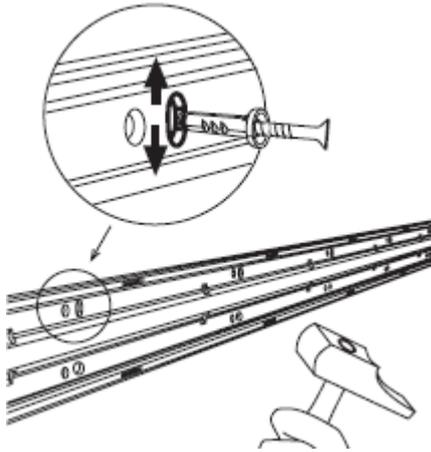
pour une fixation parfaite, des perforations permettent d'ajouter des colliers (type Colson ou Colring)
